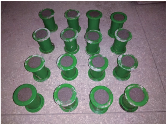
图 1 充填体试样制作
