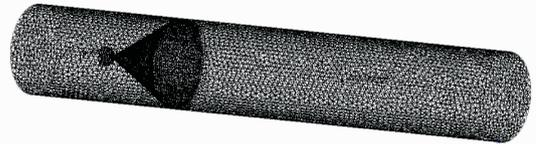
图 4 负压除尘器引射筒非结构网格图
