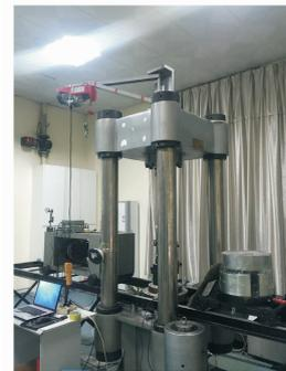
图2 三轴压缩试验系统
